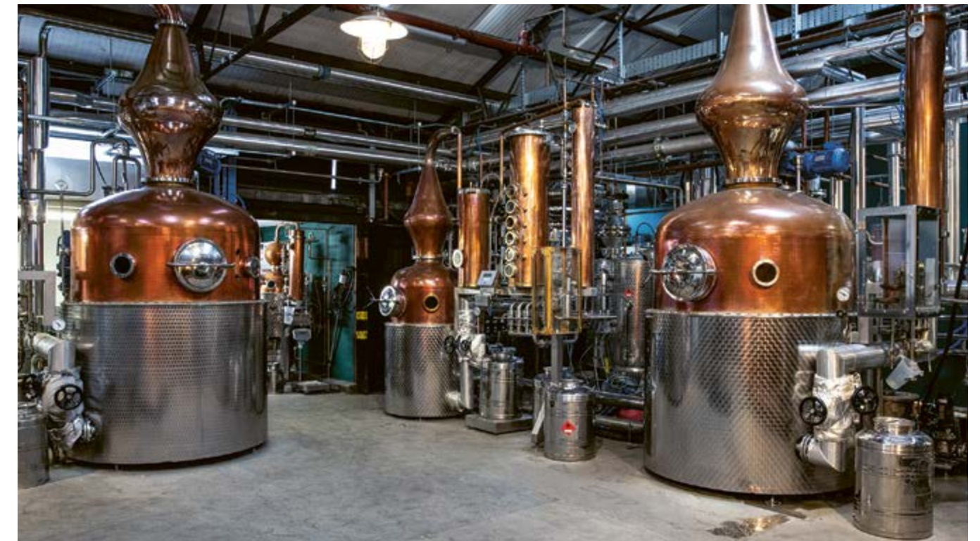
Blick in die Produktion mit zwei 1600-Liter-Destillen
